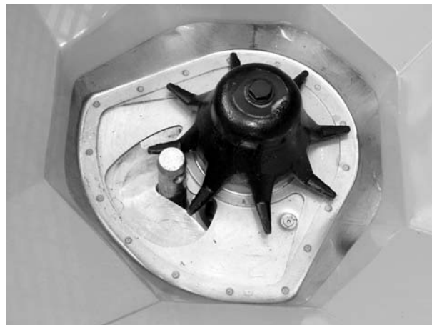
Figure 10.14 :Axe du bras inférieur dans la trappe
