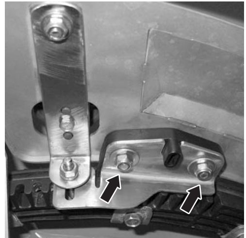
Figure 10.17 : Dévisser la plaque de réglage Point de chute
