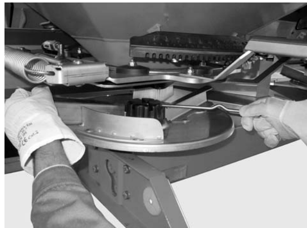
Figure 8.12 : Dévisser l'écrou borgne
