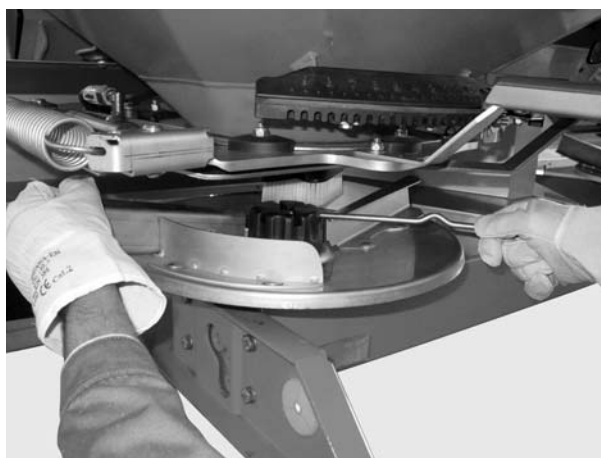
Figure 8.3 : Dévisser l'écrou borgne
