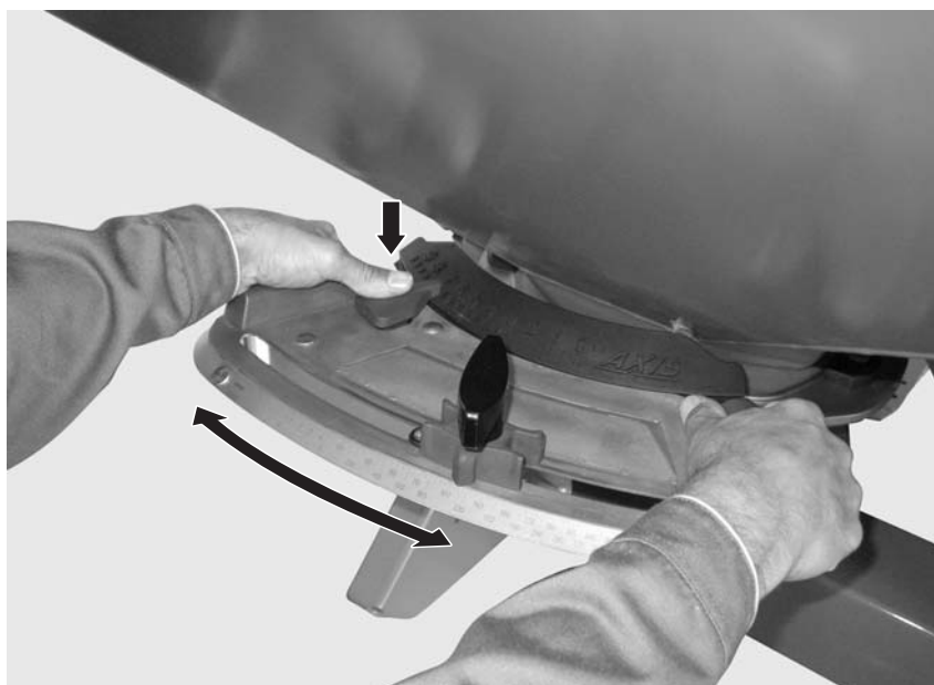
Figure 8.5 : Centre de réglage du point de chute
