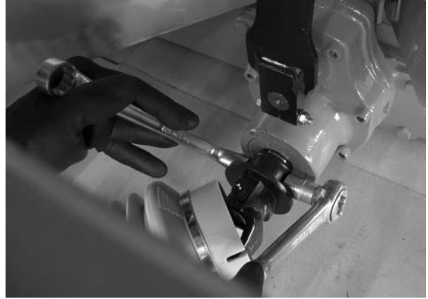
Figure 7.4 : Fixer l'arbre articulé
