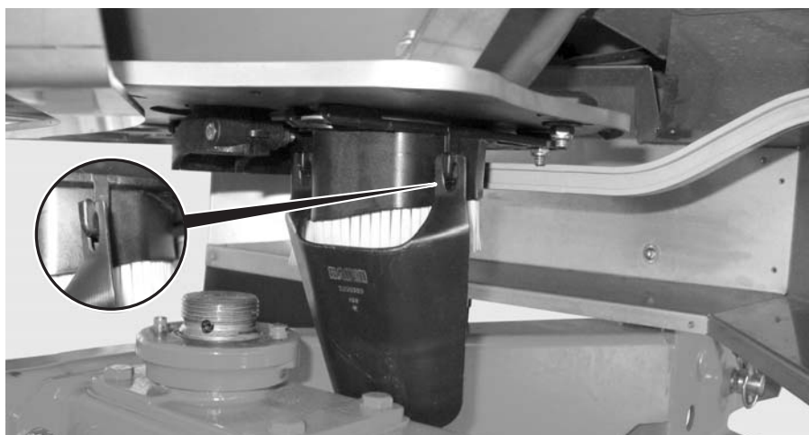
Figure 8.13 : Accrocher la goulotte de contrôle de débit
