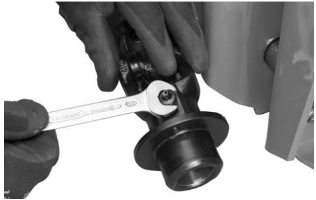
Figure 7.2 : Dévisser le graisseur
