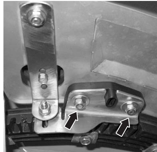
Bild 10.17: Justageblech Aufgabepunkt lösen
