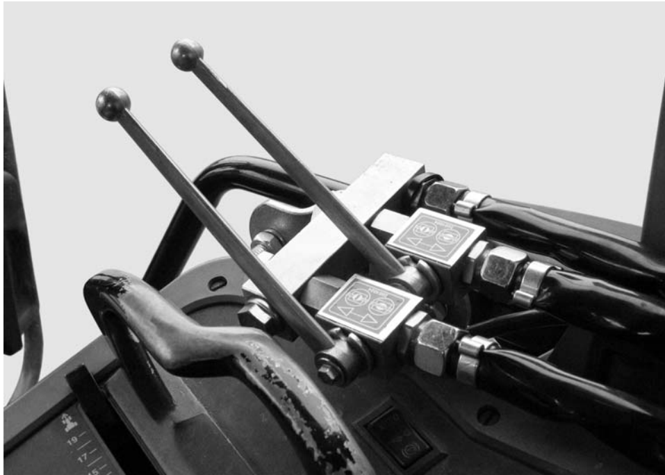
Bild 7.12: Schieberbetätigung der Zwei-Wege-Einheit
