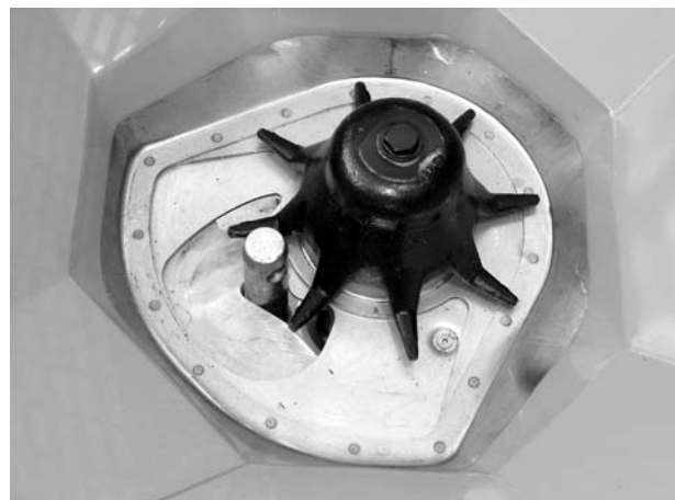
Bild 10.14: Unterlenkerbolzen in Dosieröffnung
