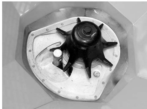
Εικόνα 9.14: Μπουλόνι κάτω συνδέσμου στο δοσιμετρικό στόμιο
