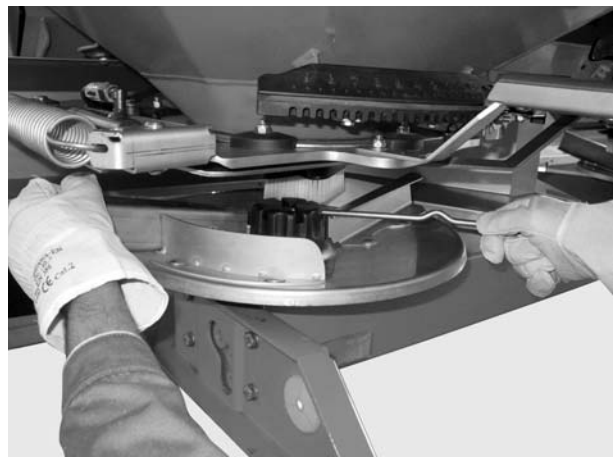
Εικόνα 8.3: Χαλάρωση τυφλού παξιμαδιού
