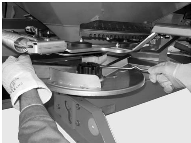
8.3. attēls: Atskrūvējiet kupoluzgriezni
