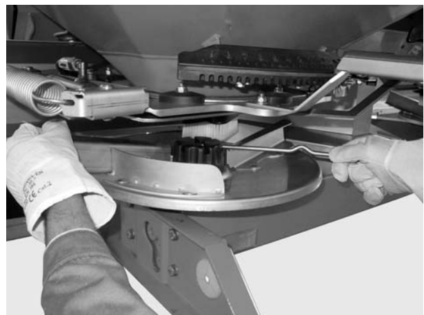
8.3 pav.: Gaubiamosios veržlės atlaisvinimas
