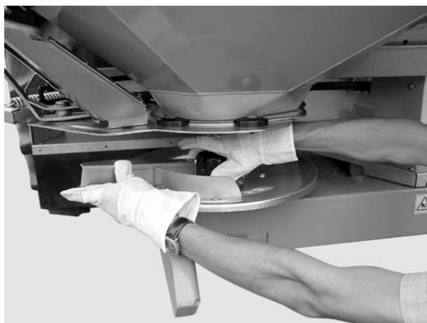
Rysunek 8.4: Odkręcanie nakrętki kołpakowej
