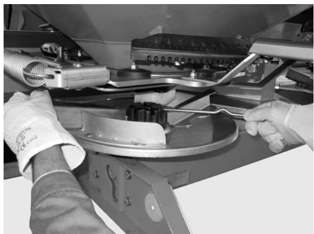
Rysunek 8.3: Luzowanie nakrętki kołpakowej
