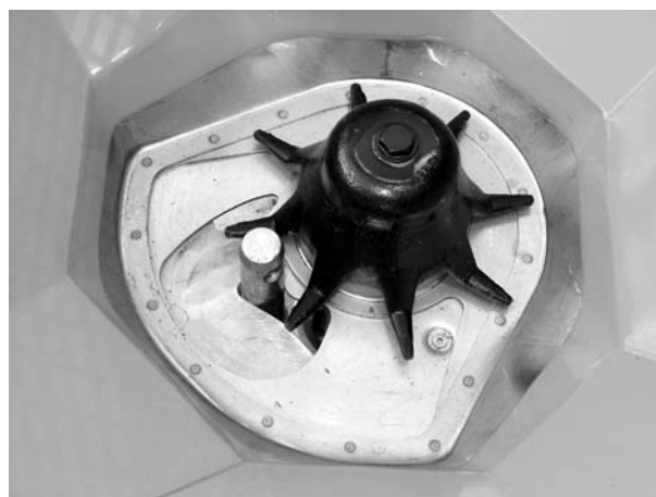
Rysunek 9.14: Trzpień dolnego ramienia podnośnika w otworze dozującym
