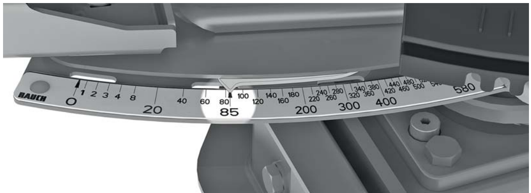
Billede 9.16: Doseringsspjældviser i position 85
