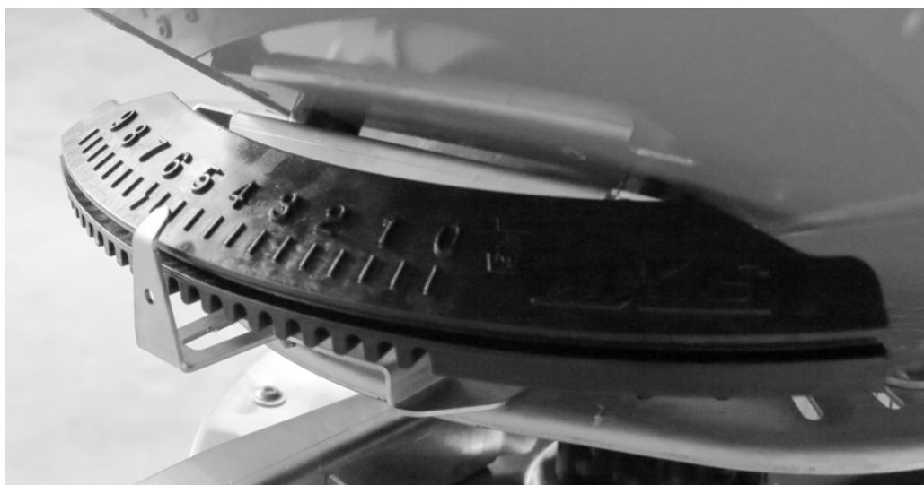
Billede 8.5: Indstillingscenter for udbringningspunkt
