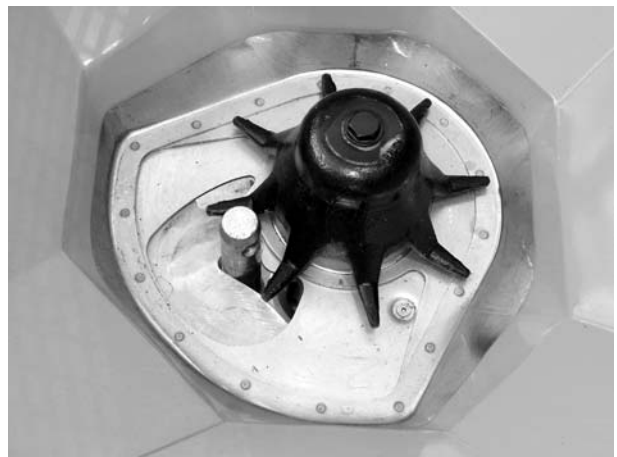
Bild 9.14: Unterlenkerbolzen in Dosieröffnung
