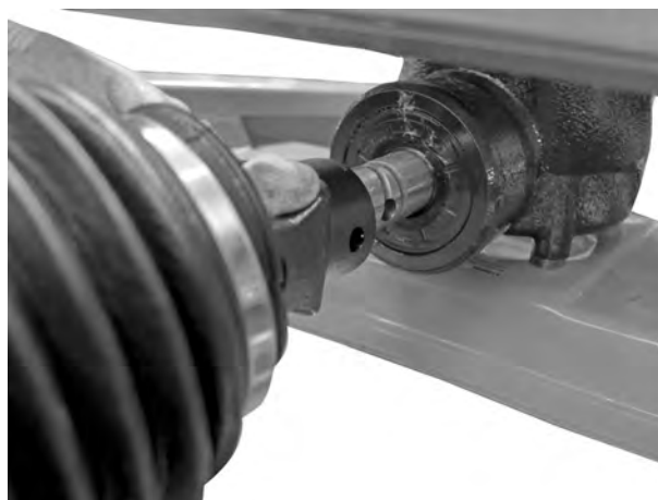
Ábr. 16: A kardántengely feltolása a hajtócsapra
