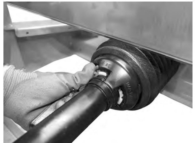
Att. 19: Kardānvārpstas aizsarga nofiksēšana
