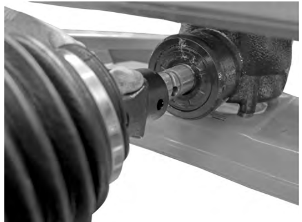
Kuva 16: Nivelakselin kiinnitys vaihdeakseliin
