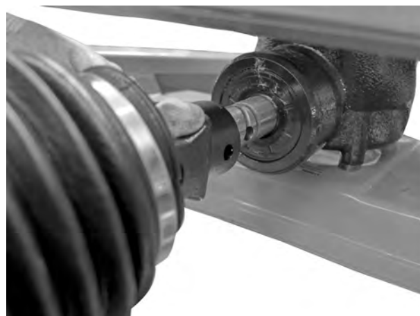
III. 16: Inserimento dell'albero cardanico sul perno del cambio
