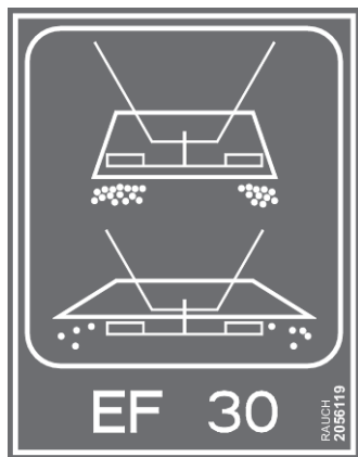
Ill. 23: Marcatura delle unità di controllo per la limitazione della larghezza di spargimento
