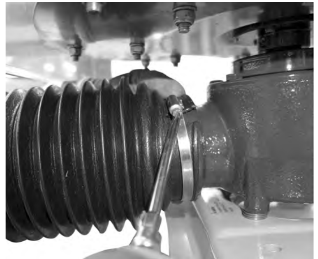
III. 18: Applicazione della protezione dell'albero cardanico
