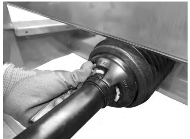
III. 19: Fissaggio della protezione dell'albero cardanico
