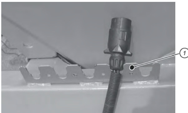
Fig. 36: Holder for kabler og slanger
