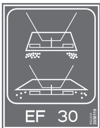
Fig. 23: Märkning av styrenhet för spridningsbredds begränsningen
