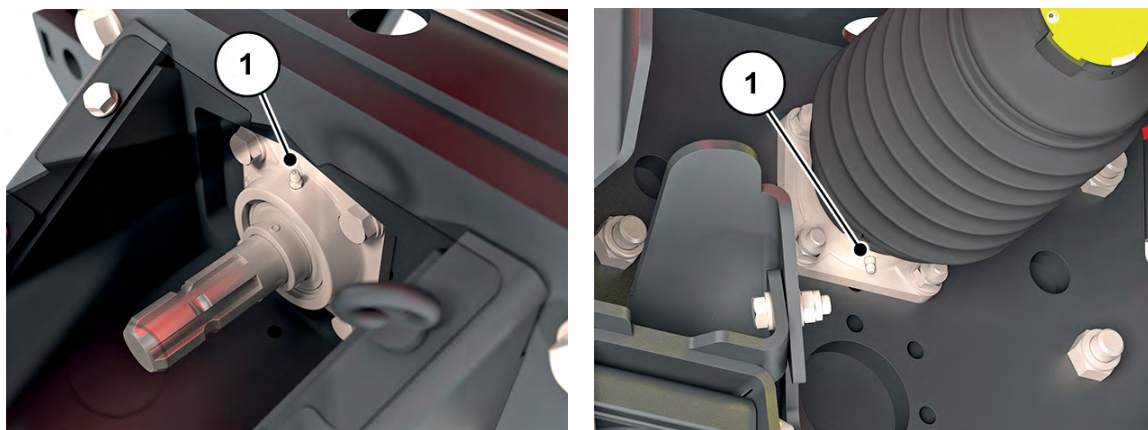
Obr. 60: Mazací místo průběžného pohonu kloubového hřídele
