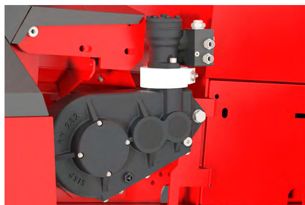
Obr. 66: Kontrola motoru a hydraulického bloku pohonu dopravního pásu
