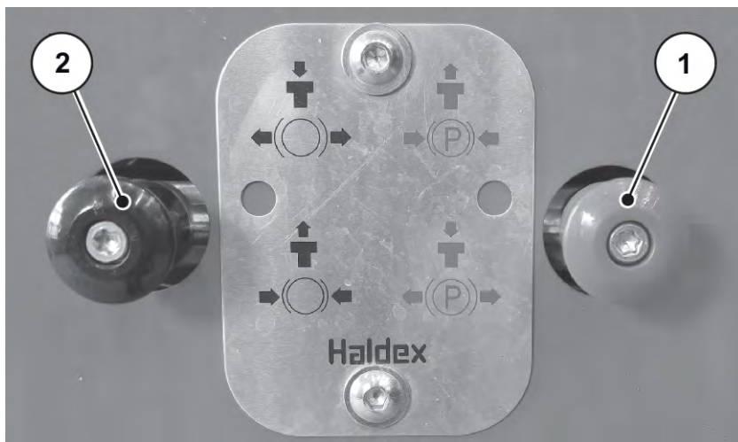
图 46: 拉动手动驻车制动器
