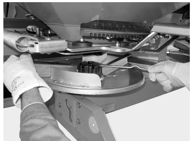
Obr. 40: Uvoľnenie uzavretej matice
