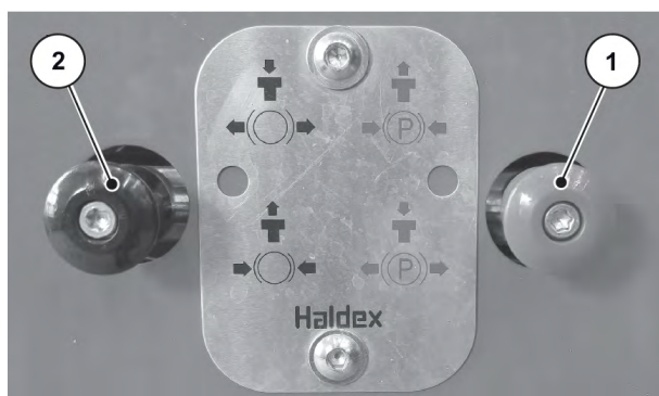
Obr. 30: Uvoľnenie parkovacej brzdy
