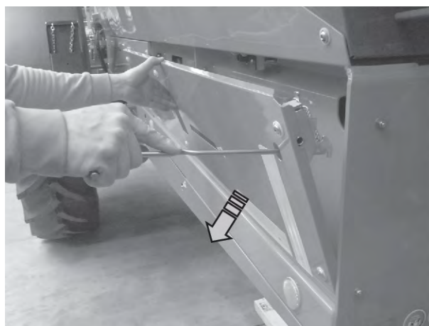
Obr. 53: Vyklopenie bočného krytu
