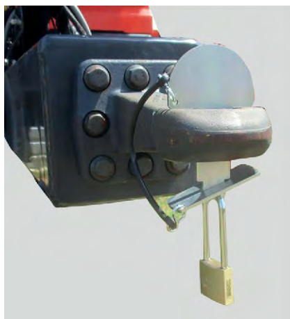
Obr. 14: Poistka proti neoprávnenému použitiu na závesných zariadeniach
