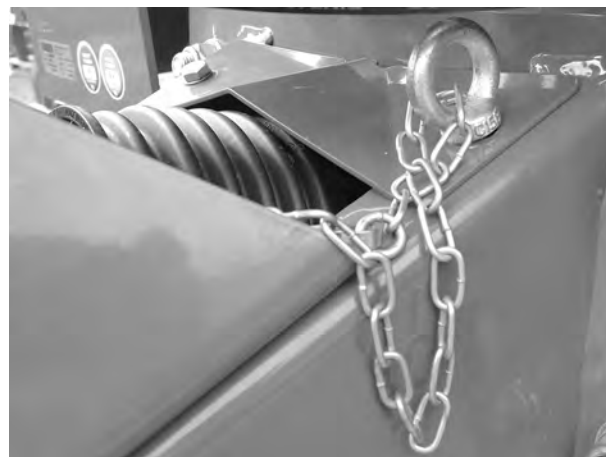
Obr. 22: Upevnenie prídržnej reťaze
