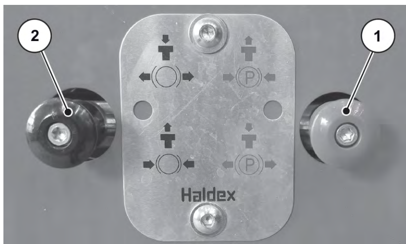
Obr. 46: Utiahnutie manuálnej parkovacej brzdy
