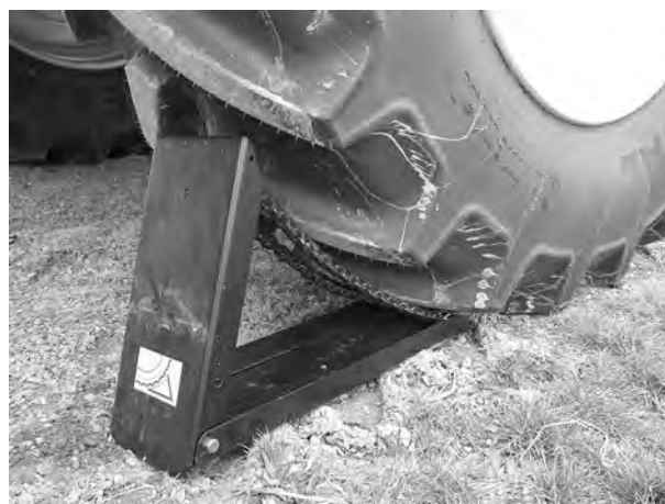
Ilust. 48: Colocación de la cuña
