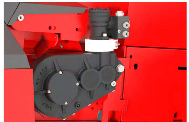
Ilust. 66: Comprobación del motor y del bloque hidráulico del accionamiento de la cinta transportadora
