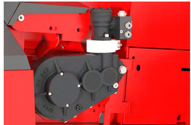
Abb. 66: Motor und Hydraulikblock des Förderband-Antriebs prüfen
