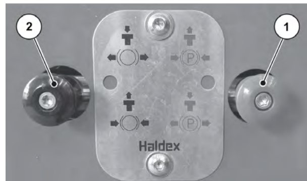
Ilust. 77: Accionar el freno de estacionamiento manualmente
