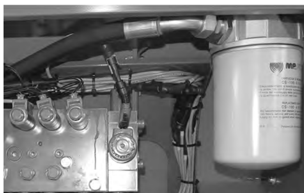
Ilust. 105: Filtro de aceite del bloque de control
