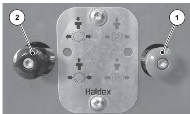
Ilust. 31: Liberación del freno de estacionamiento
