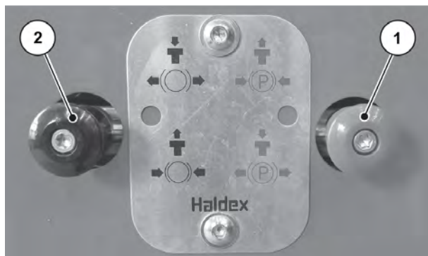
Pav. 31: Stovėjimo stabdžio atlaisvinimas
