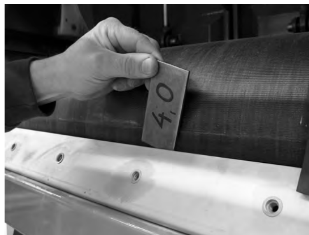
Pav. 122: Atstumo tikrinimas
