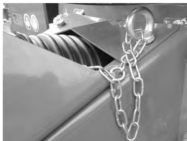
Pav. 24: Laikančiosios grandinės pritvirtinimas
