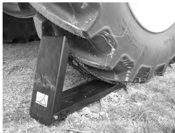
Pav. 79: Nustatykite po ratais dedamos nuo riedėjimo apsaugančios trinkelės padėtį
