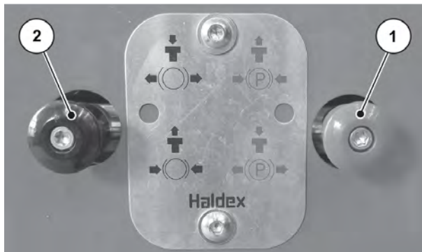
Ábr. 31: Rögzítőfék kioldása
