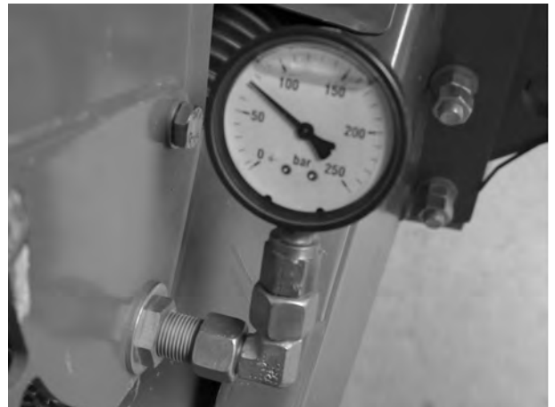
Ábr. 115: Nyomásmérő a kábelvezetésen a vonórúdnál
