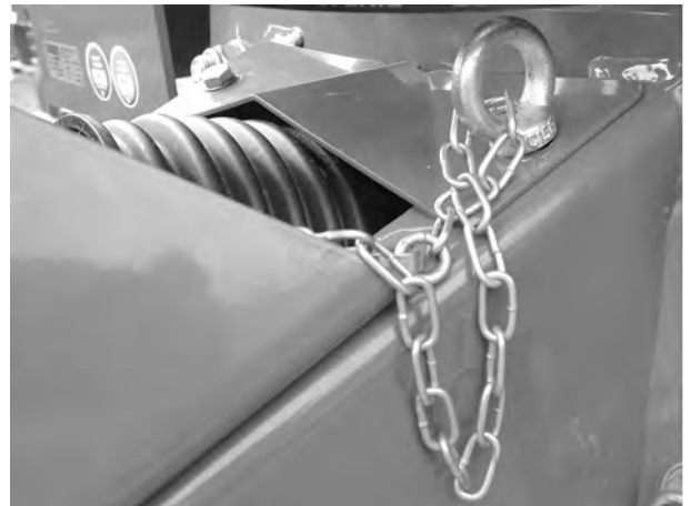
Ábr. 24: A tartólánc rögzítése
