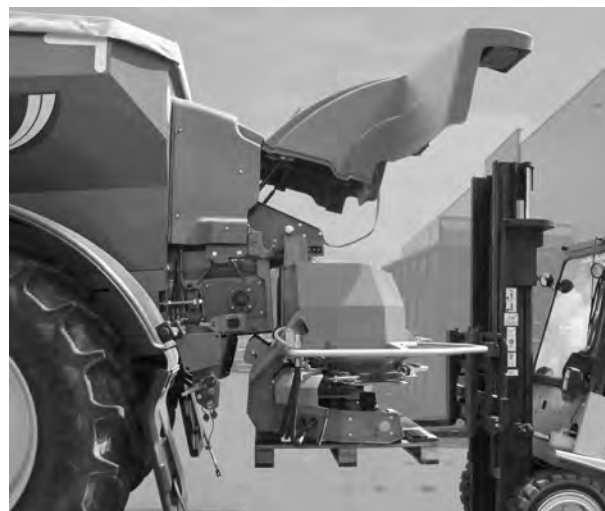
Rys. 43: Podjazd wózkiem widłowym
