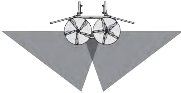
Rys. 72: Normalny obraz wysiewu, punkt podawania w położeniu neutralnym
