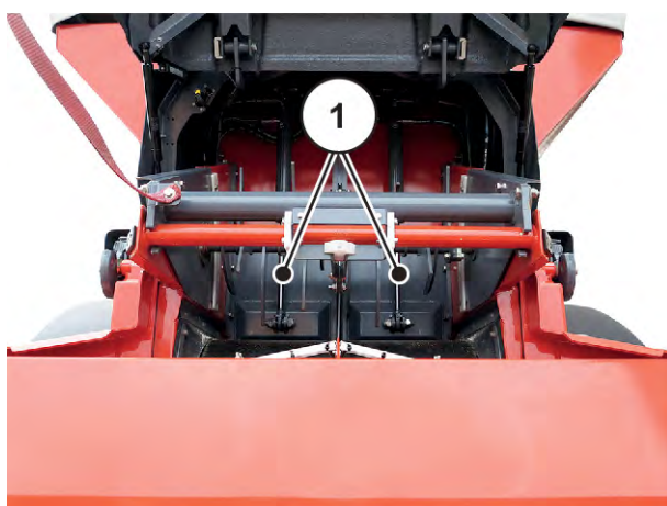
Rys. 49: Zasuwa wstępnego dozowania w położeniu zamkniętym
