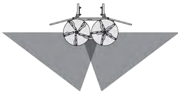
Obr. 72: Normální obraz rozmetání, bod výpadu v neutrální poloze
