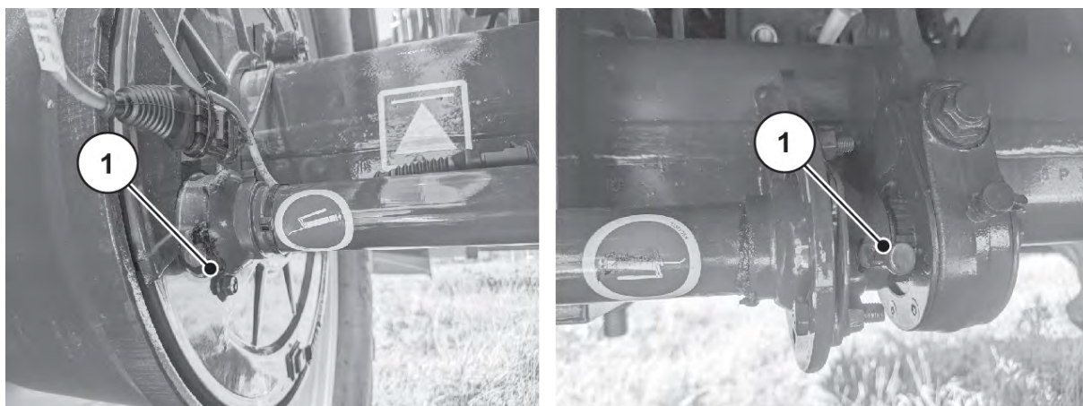
Obr. 92: Uložení hřídele klíče brzdy tuhé nápravy
