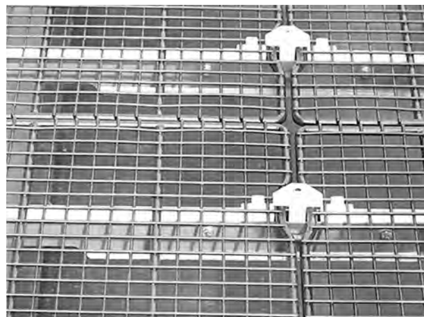
Obr. 41: Plnicí síto v zásobníku
