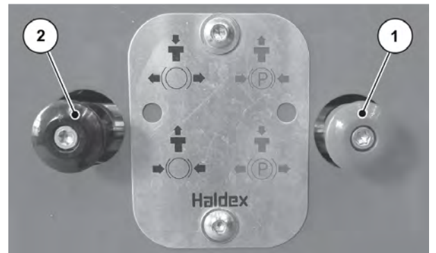
Obr. 77: Ruční zatažení parkovací brzdy
