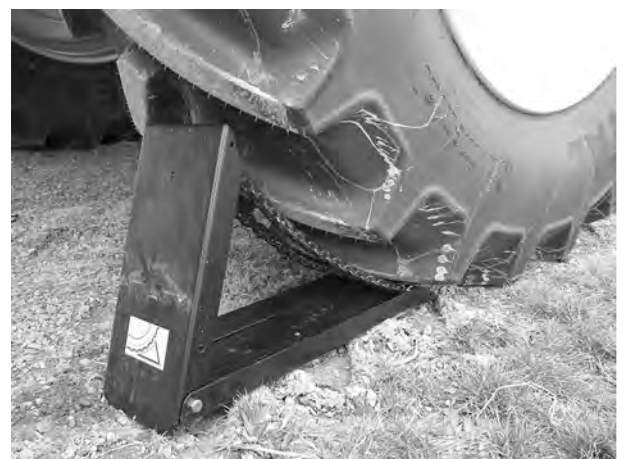
Obr. 79: Umístění klínů pod kola
