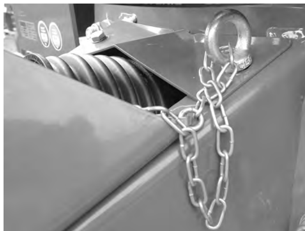
Obr. 24: Upevnění připevňovacího řetízku
