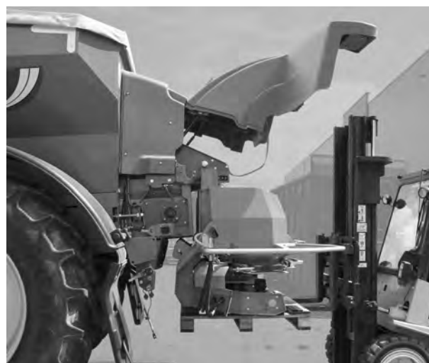
Obr. 43: Najetí vidlicovým vysokozdvížným vozíkem
