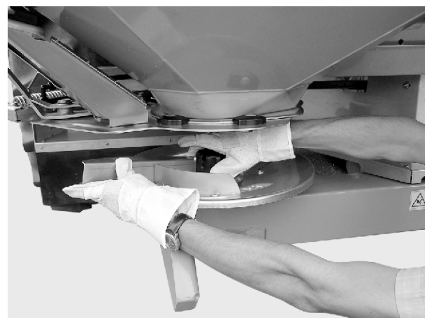
Obr. 66: Odšroubování uzavřené matice
