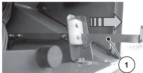
Obr. 84: Páka čisticí klapky
