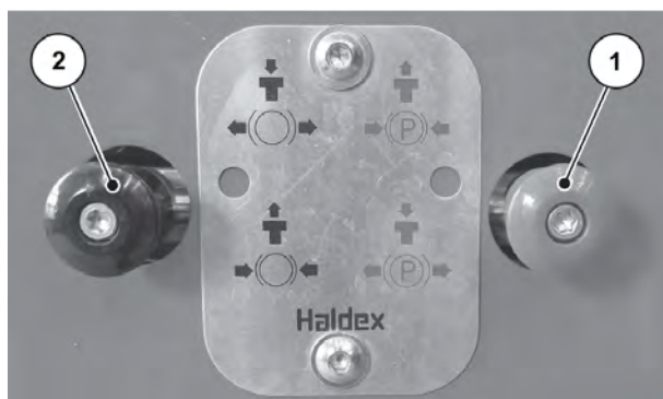
Obr. 31: Odbrzdnění parkovací brzdy
