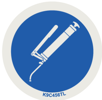
Fig. 85: Henvisningsskilt for smørested
