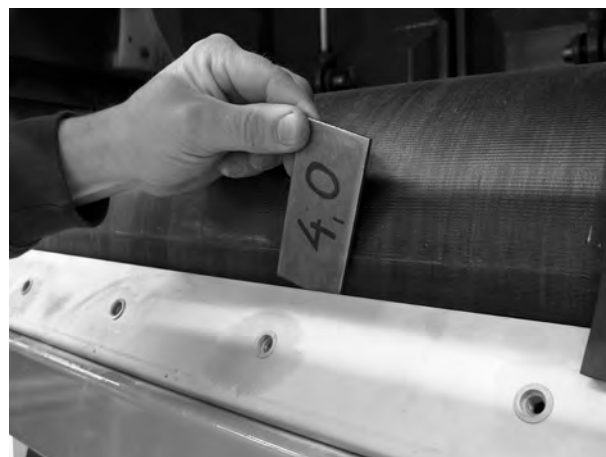
Fig. 122: Kontrol af afstanden
