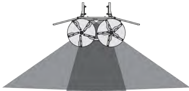
Fig. 76: For meget gødning eller kalk i midten:
