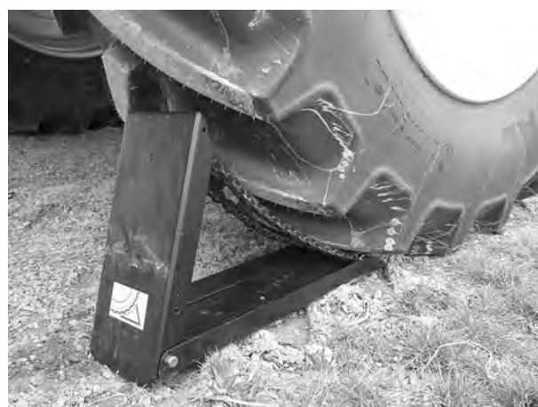
Fig. 79: Placering af stopklodser
