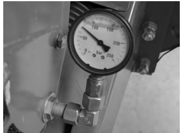
Fig. 115: Manometer på kabelføring over vognstang
