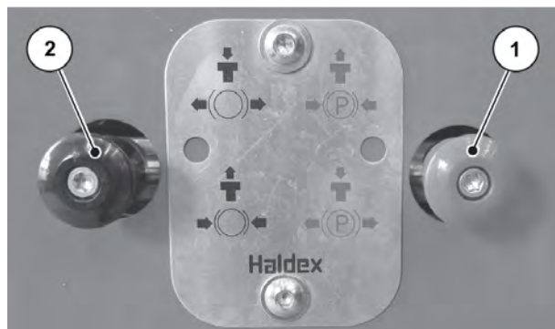
Fig. 31: Slækning af parkeringsbremsen
