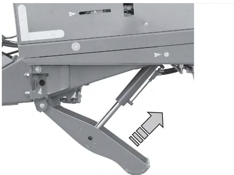
Fig. 27: Indkøring af støttefoden
