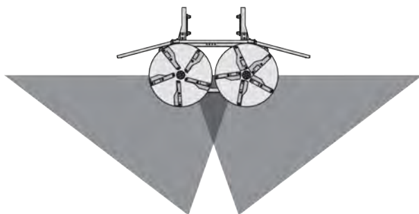
Fig. 72: Normalt spredebillede, udbringningspunkt i neutralstilling
