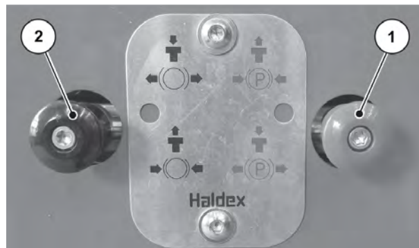
Afb. 77: Handmatige parkeerrem aantrekken
