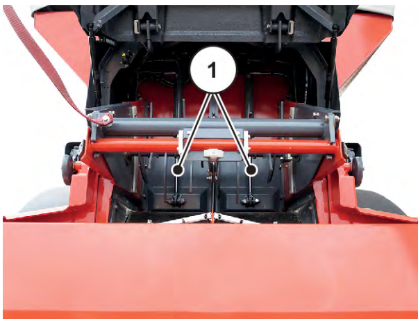
Att. 52: Iepriekšējās dozēšanas aizbīdņi ir aizvērtā stāvoklī
