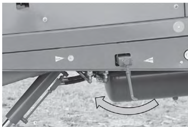
Att. 84: Manuālās stāvbremzes iedarbināšana
