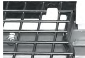
Att. 42: Iepildīšanas sieta montāža
