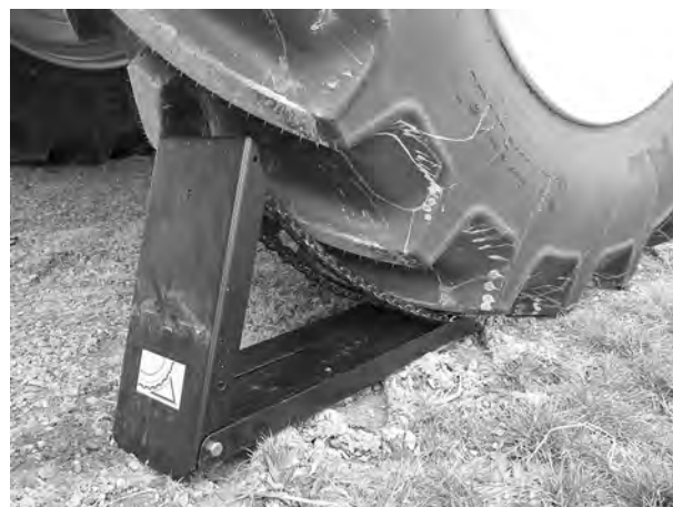
Att. 86: Riteņa atbalsta ķīļa pozicionēšana
