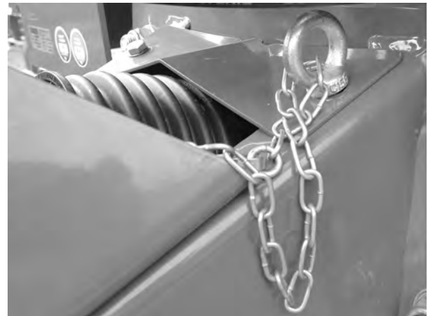
Att. 25: Ķēdes nostiprināšana
