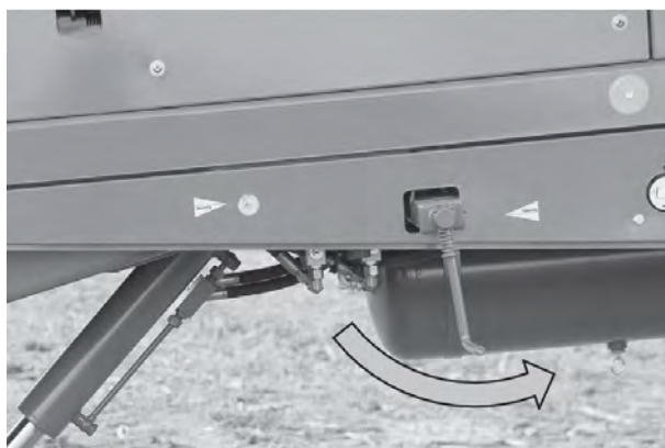
Att. 34: Manuālās stāvbremzes atbrīvošana
