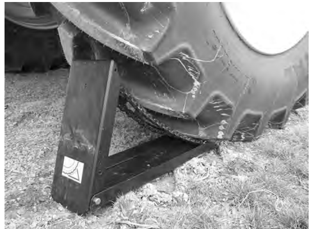
Att. 82: Riteņa atbalsta ķīļa pozicionēšana
