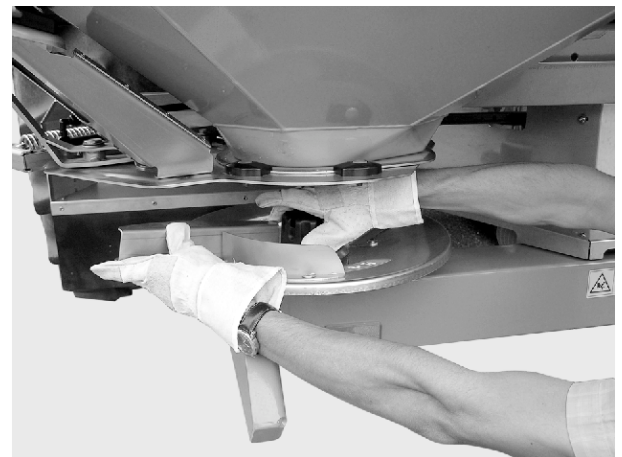
Fig. 66: Skruva loss hattmuttern
