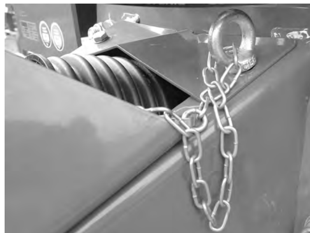
Fig. 24: Sätt fast hållkedjan
