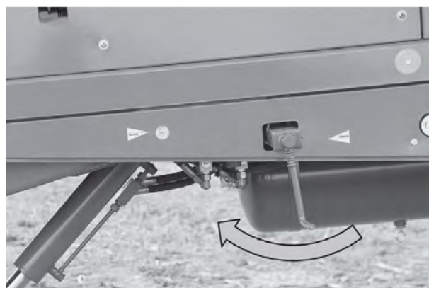
Pav. 84: Rankinio stovėjimo stabdžio įjungimas
