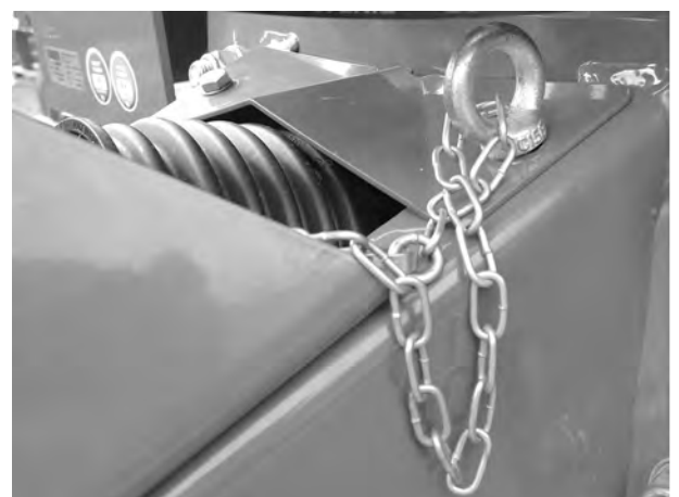
Pav. 25: Laikančiosios grandinės pritvirtinimas
