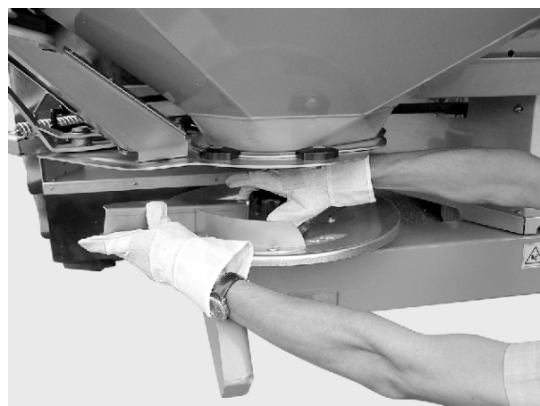
Pav. 69: Gaubiamosios veržlės atsukimas
