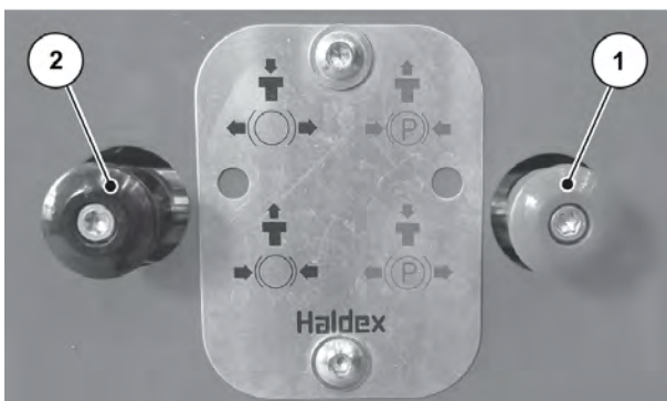
Pav. 33: Stovėjimo stabdžio atlaisvinimas
