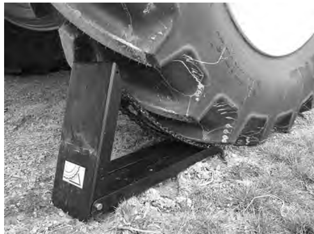
Imagine 7.25: Poziționare pană de blocare
