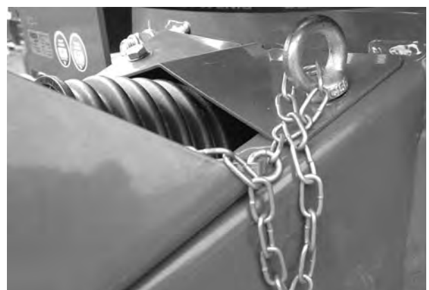
Imagine 6.5: Fixați lanțul de susținere
