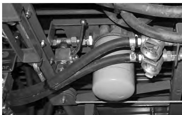
Imagine 9.28: Filtru de ulei suspensie oiște
