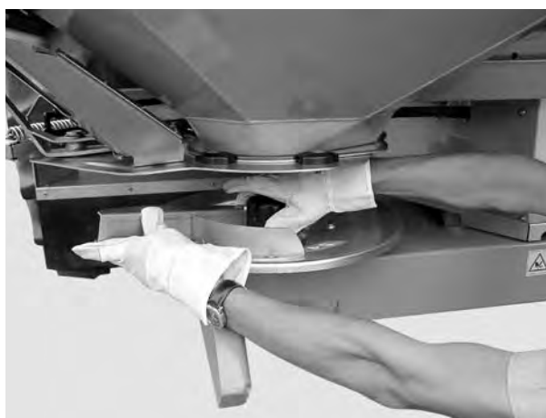
Imagine 7.12: Deșurubați piulița cu pălărie
