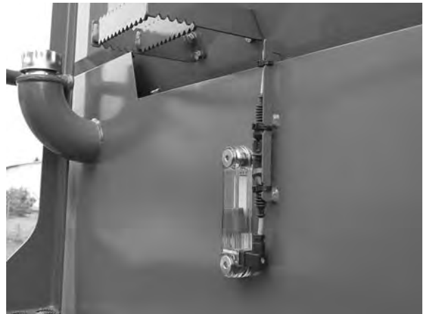
Imagine 9.25: Poziție afișare stare de plin ulei
