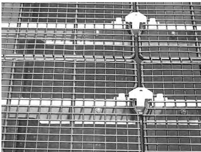
Imagine 6.22: Asigurați sita de umplere în recipient
