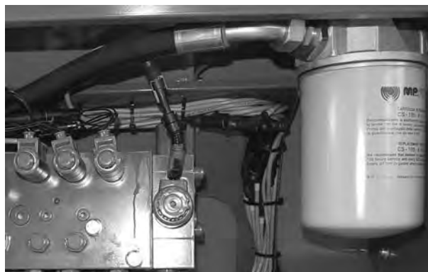
Imagine 9.27: Filtru de ulei bloc de comandă
