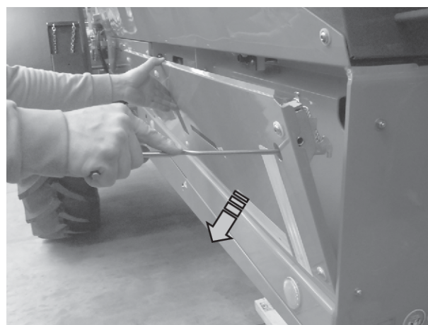
Att. 84: Sānu pārsega atvēršana
