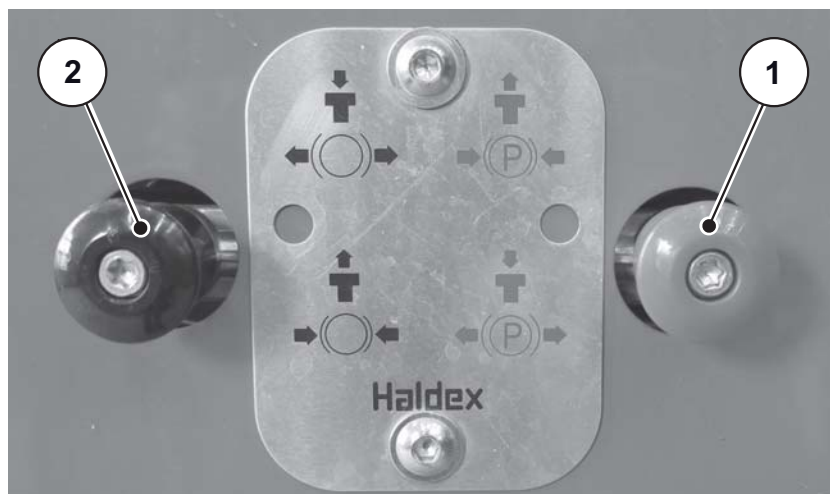
Joonis 7.20: Manuaalse seisupiduri vabastamine
