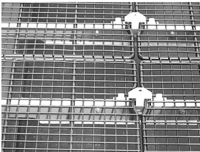
Joonis 6.24: Kinnitage täitesõel punkrisse.
