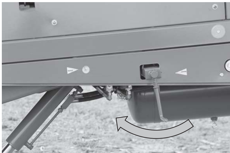
Joonis 7.21: Manuaalse seisupiduri rakendamine
