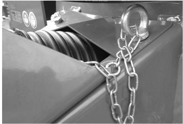
Joonis 6.5: Kinnitusketi kinnitamine
