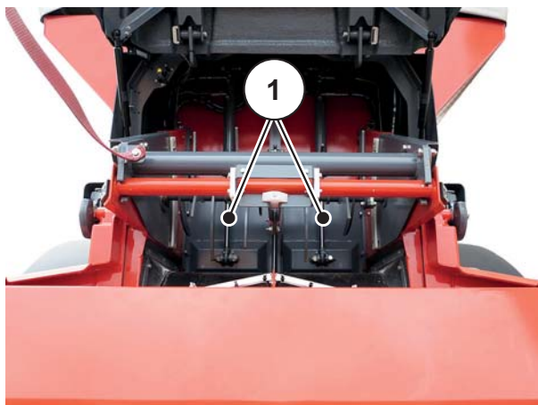
Joonis 6.32: Eeldoseerimisklapp suletud asendis
