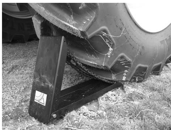
Joonis 7.23: Paigaldage tõkiskingad
