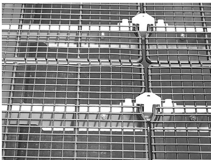
Rysunek 6.24: Zabezpieczenie sita zasypowego w zbiorniku
