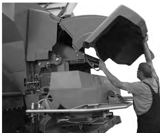
Afb. 7.2: Aan de trekband trekken
