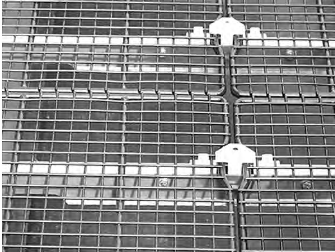
Afb. 6.24: Vulzeef in de voorraadbak zekeren
