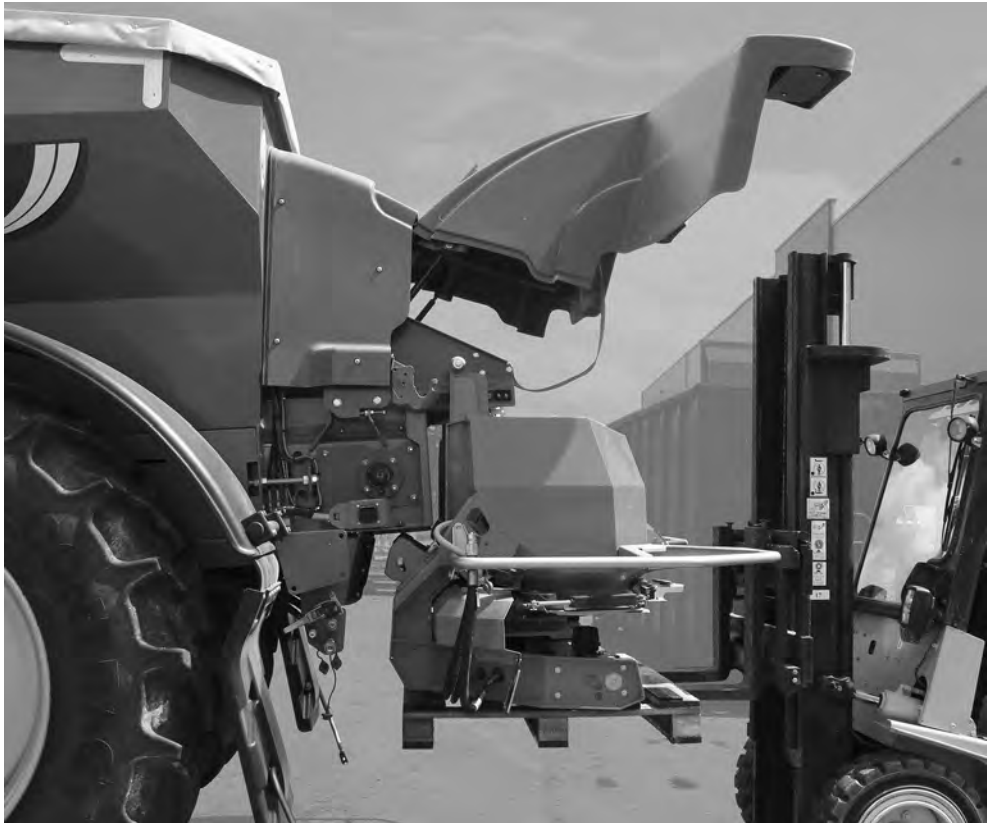
Afb. 6.26: Vorkheftruck tot aan de grote strooier rijden
