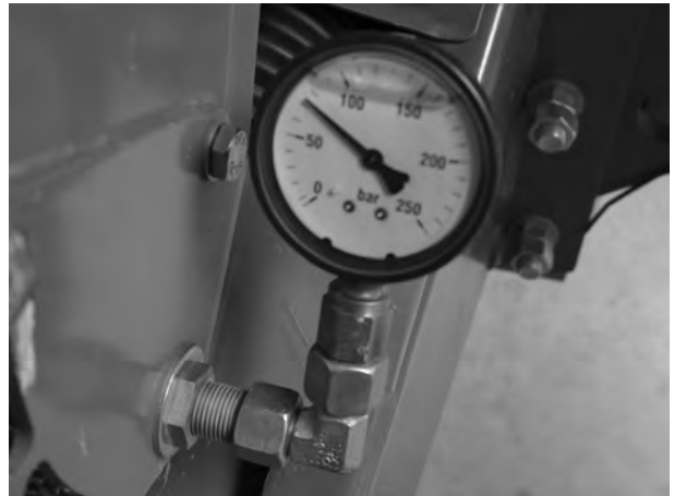
Afb. 9.16: Manometer aan kabelgeleiding boven dissel
