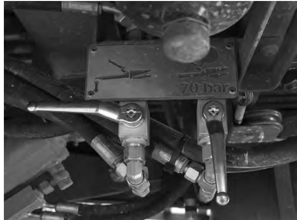
Afb. 9.14: Linker afsluiter sluiten
