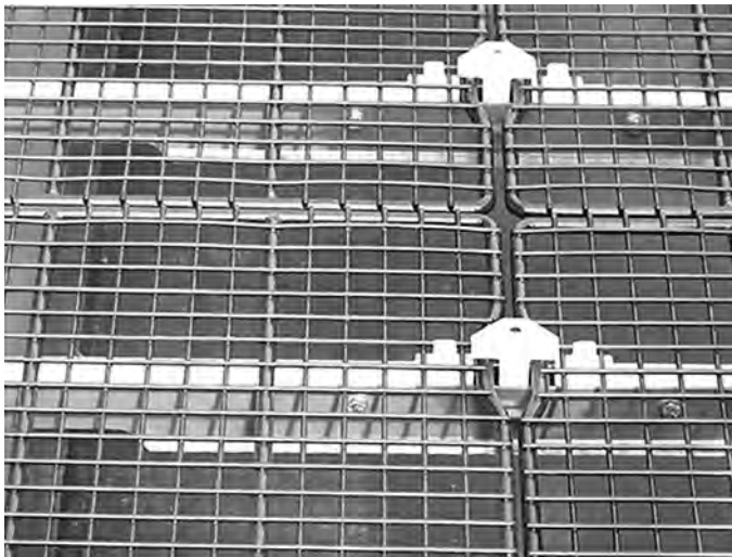
Figure 6.24 : Sécuriser le tamis de remplissage dans la trémie
