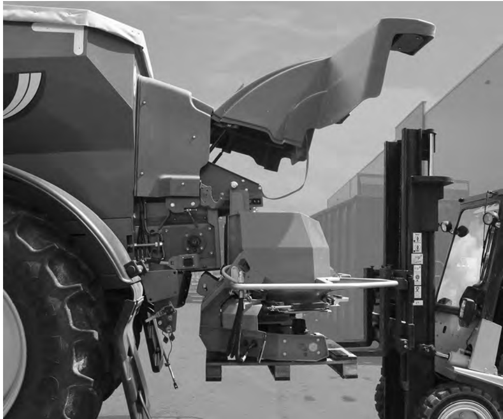
Figure 6.26 : Approcher le chariot élévateur à fourche.
