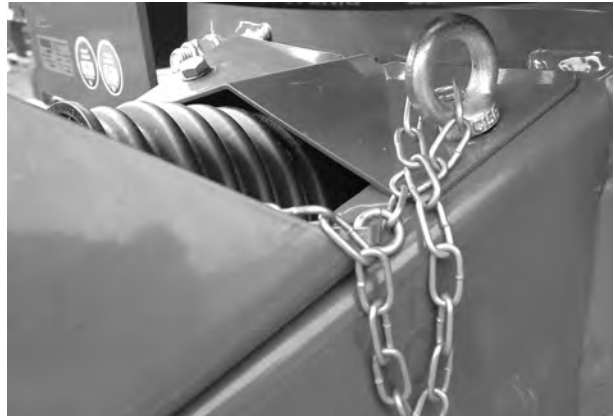
Figure 6.5 : Fixer la chaîne de maintien
