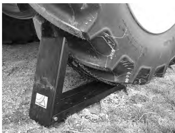
Figure 7.23 : Positionner une cale
