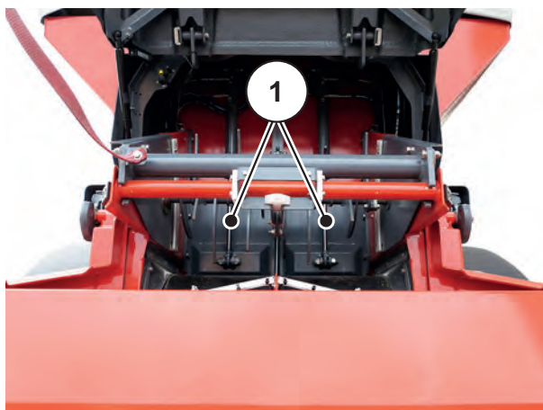
Figure 6.32 : Vannes de pré-dosage en position fermée.
