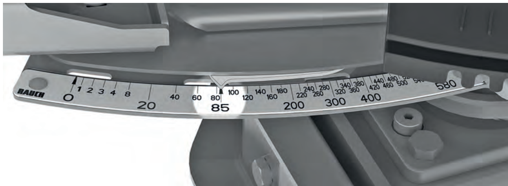
Figure 7.11 : Échelle graduée indiquant la dose d'épandage
