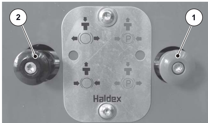
Slika 6.12: Otpuštanje parkirne kočnice
