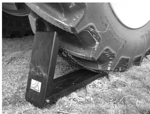
Slika 7.23: Pozicionirajte potporni klin
