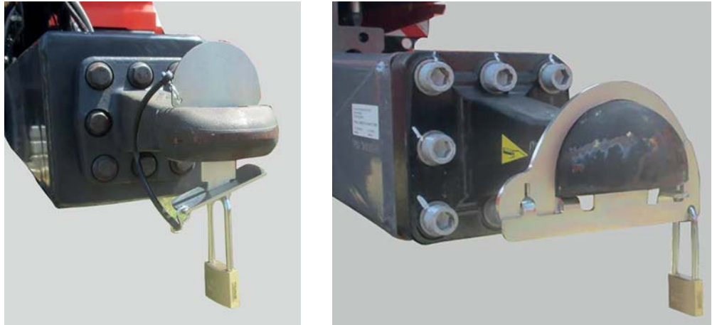
Slika 3.7: Osiguranje od neovlaštene upotrebe na priključnim sklopovima
