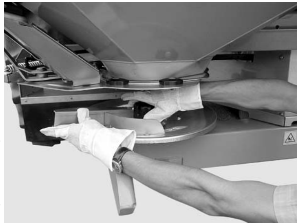
Slika 7.9: Odvijte zaobljenu slijepu maticu
