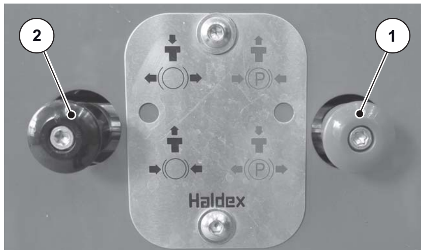
Slika 7.20: Ručno otpuštanje parkirne kočnice
