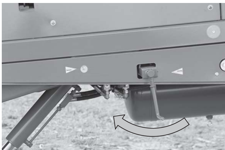
Slika 7.21: Ručno pritezanje parkirne kočnice
