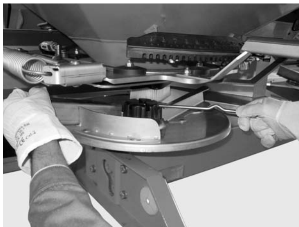
Slika 7.8: Otpustite zaobljenu slijepu maticu
