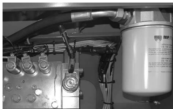
Slika 9.31: Filtar ulja na upravljačkom bloku
