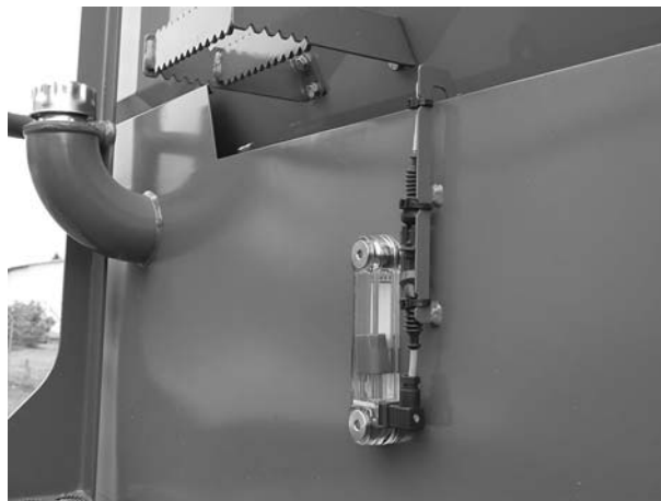
Slika 9.29: Položaj prikaza razine napunjenosti ulja
