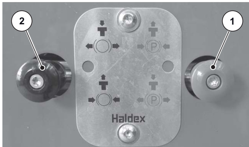
Slika 6.10: Kočnica s komprimiranim zrakom
