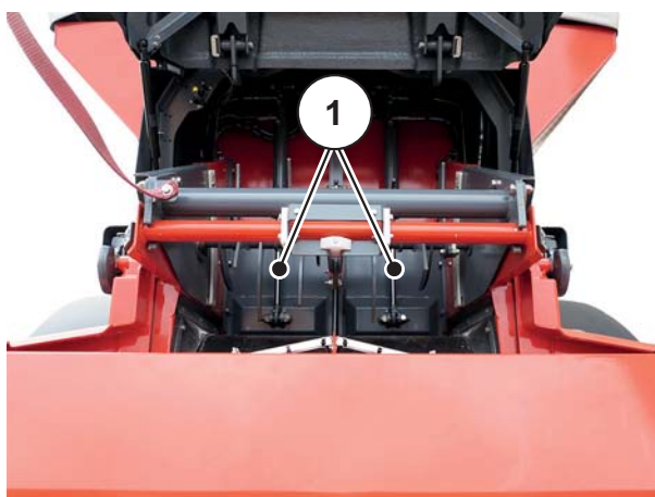
Slika 6.32: Klizač za preddoziranje u zatvorenom položaju
