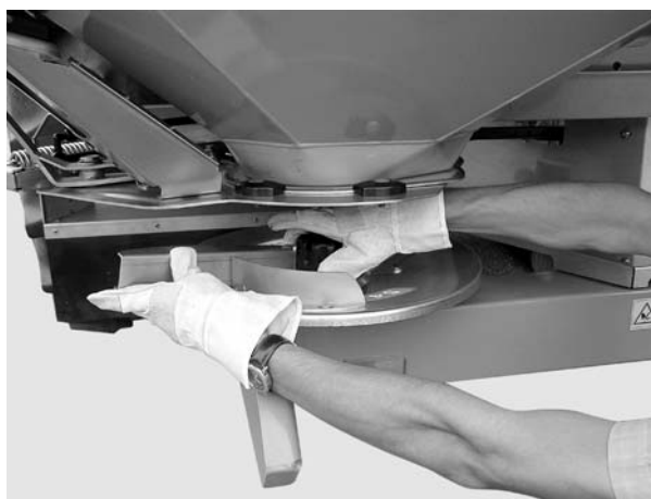
Joonis 7.9: Kübarmutri lahtikeeramine
