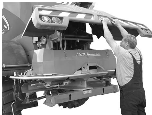
Joonis 7.3: Haarake kaitsekatte käepidemetest
