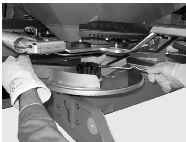
Joonis 7.8: Keerake kübarmutter lahti
