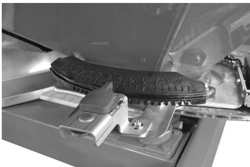
Attēls 7.10: Rādījums padeves punktam
