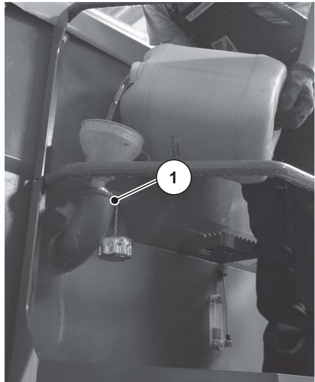
9.29. attēls: Eļļas iepildīšana
