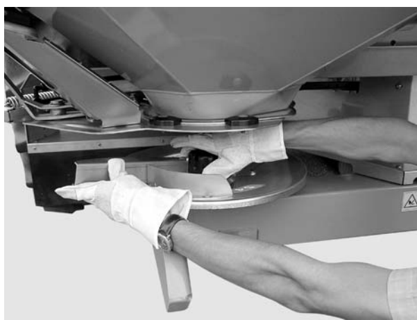
Attēls 7.9: Kupoluzgriežņa noskrūvēšana
