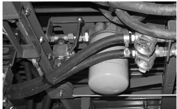
9.28. attēls: Dīzeles atsperojuma eļļas filtrs
