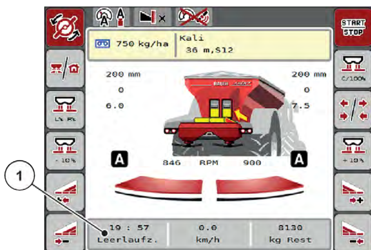
Fig. 47: Visning av tomgångsmätningen i driftsbilden.
