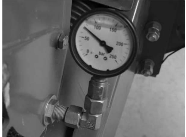
9.14 ábra: Nyomásmérő a kábelvezetésen a vonórúdnál
