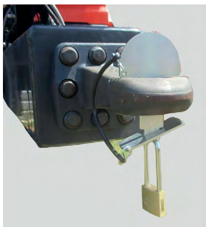
Fig. 10: Protection contre une utilisation non autorisée sur les dispositifs d'attelage
