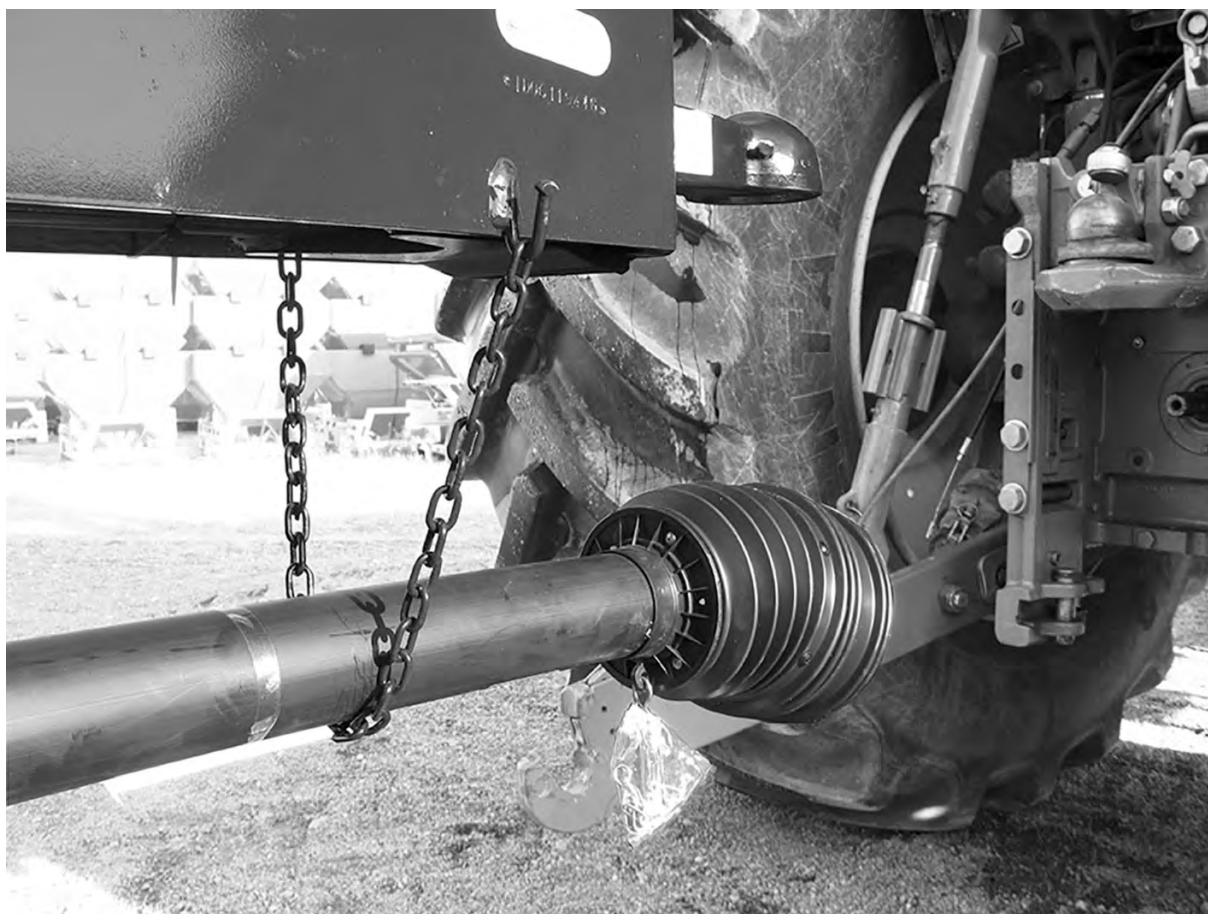
Fig. 24: Dépose de l'arbre de transmission
