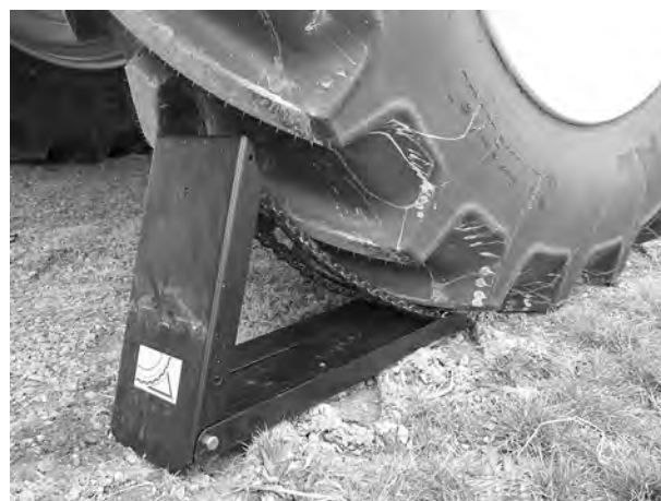
Fig. 55: Positionner une cale
