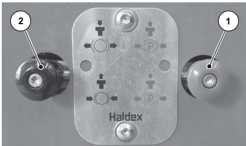
Fig. 53: Serrage du frein de stationnement manuel
