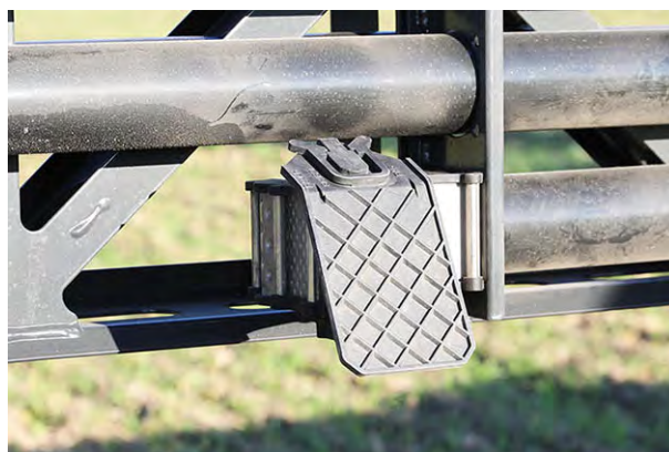
Fig. 46: Déflecteur en épandage normal
