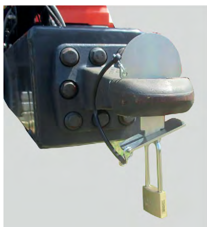
Rys. 10: Zabezpieczenie przed nieuprawnionym użytkowaniem zaczepu holowniczego
