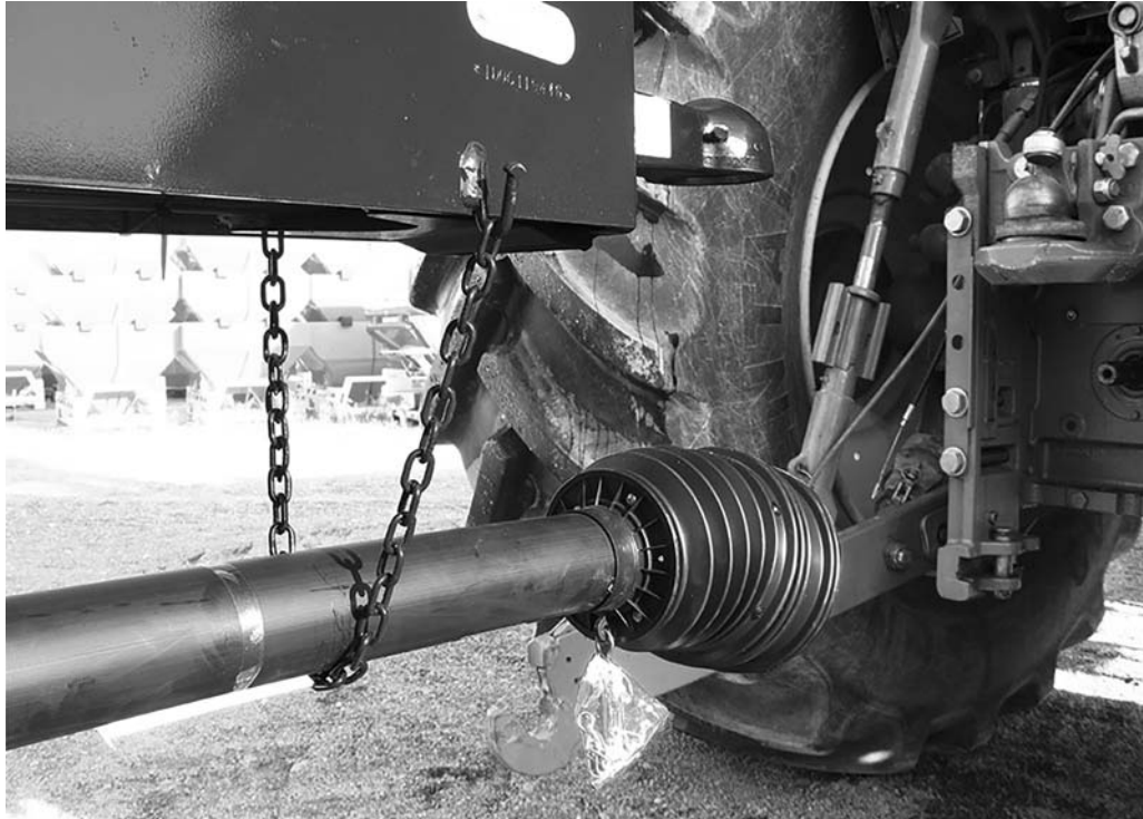
Afb. 6.6: Neerleggen van de aftakas
