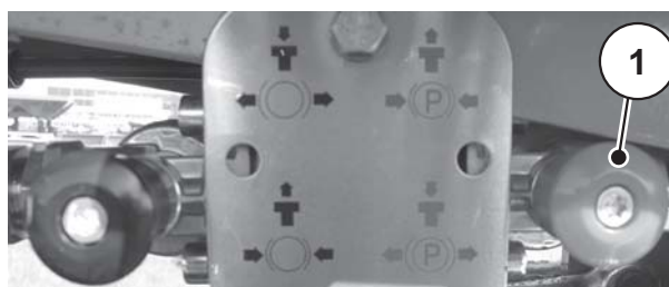
Afb. 8.1: Parkeerrem ontkoppelen (pneumatische reminstallatie)
