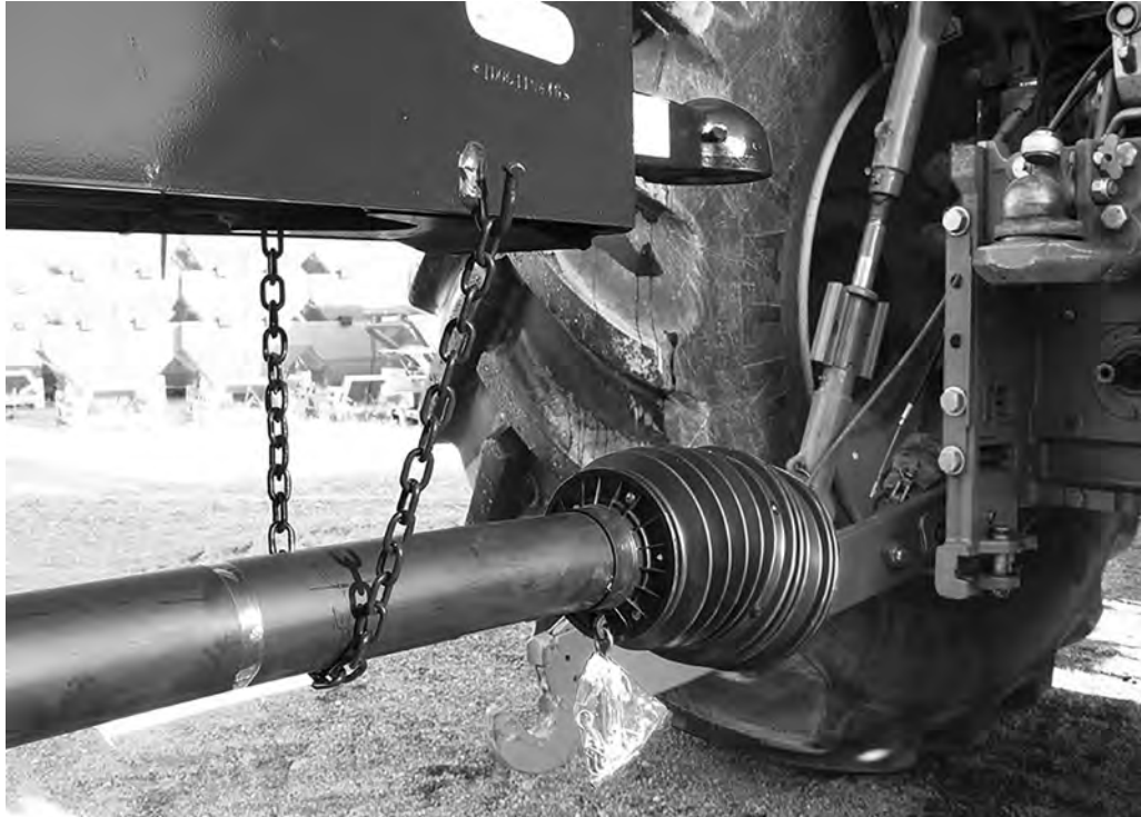
Bild 6.6: Lägg ner kraftöverföringsaxeln
