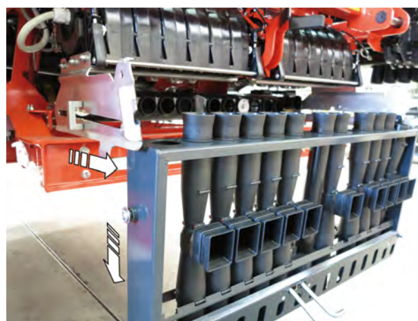
Rys. 32: Opuszczanie kasety iniektora
