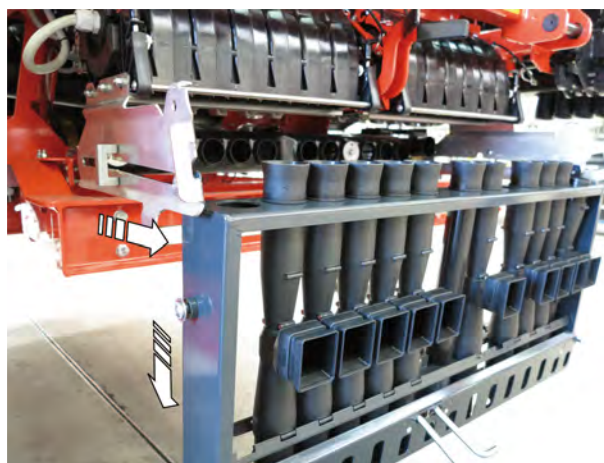
Rys. 51: Opuszczanie kasety iniektora
